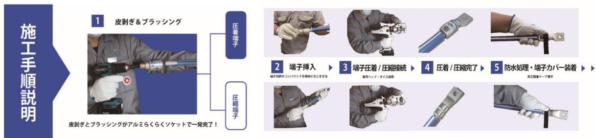
[注意] アルミケーブルの他、専用圧縮・圧着端子、端子台、端末処理専用工具が必要です。
